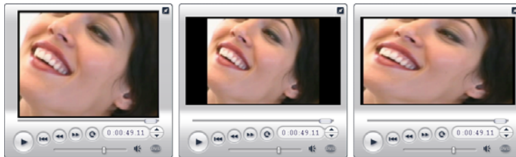
(G) Format original 4/3 ; (C) même format avec barres noires en cas d'ajout dans un projet 16/9 ; (D) même format après utilisation de la commande Format d'image 16/9.
